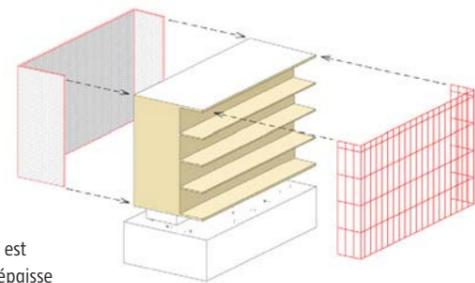
La structure en CLT est protégée par une épaisse vèture côté nord et par une façade vitrée type serre côté sud.
