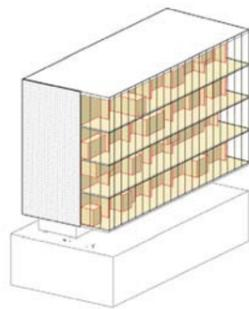
Ainsi isolée et protégée des intempéries, la façade sud peut être «sculptée» à loisir par l'assemblage de panneaux de CLT brut formant autant de boîtes, de retraits et de balcons intérieurs.
